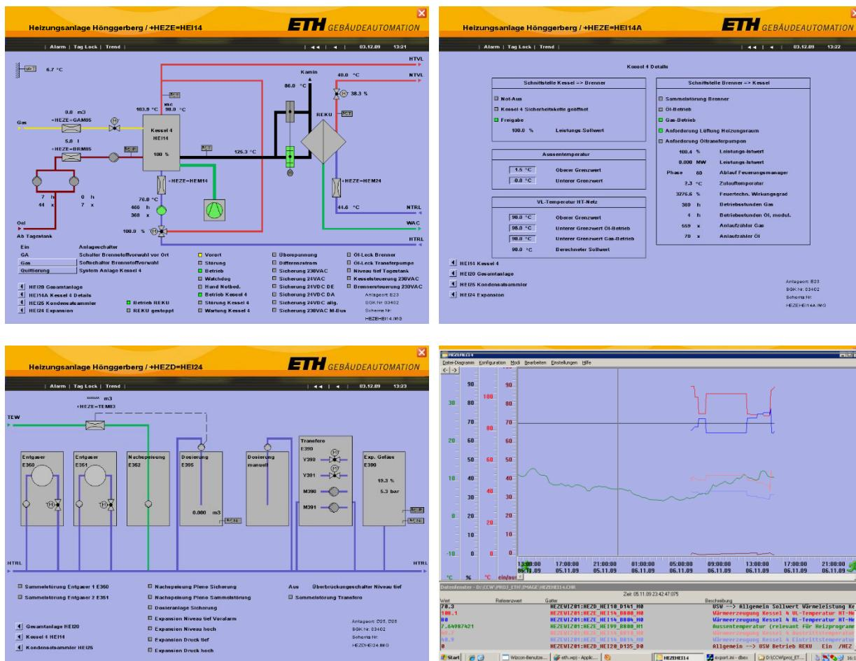
Realisierung von einer kombinierten Gas- und Ölheizung des gesamten Gebäudes, von der Vorabklärung bis zur Inbetriebnahme. Integration in das bestehende Prozessleitsystem.
